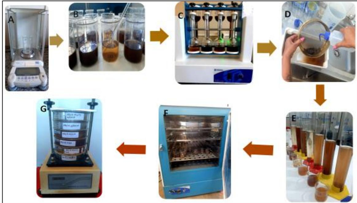
(A) Balança de precisão, (B) Béqueres com sedimentos, (C) Agitador de garrafas, (D) Lavagem de sedimentos na peneira, (E) Sedimentos descansando na proveta, (F) Estufa para secagem, (G) Agitador de peneiras para separação de granulômetros.
