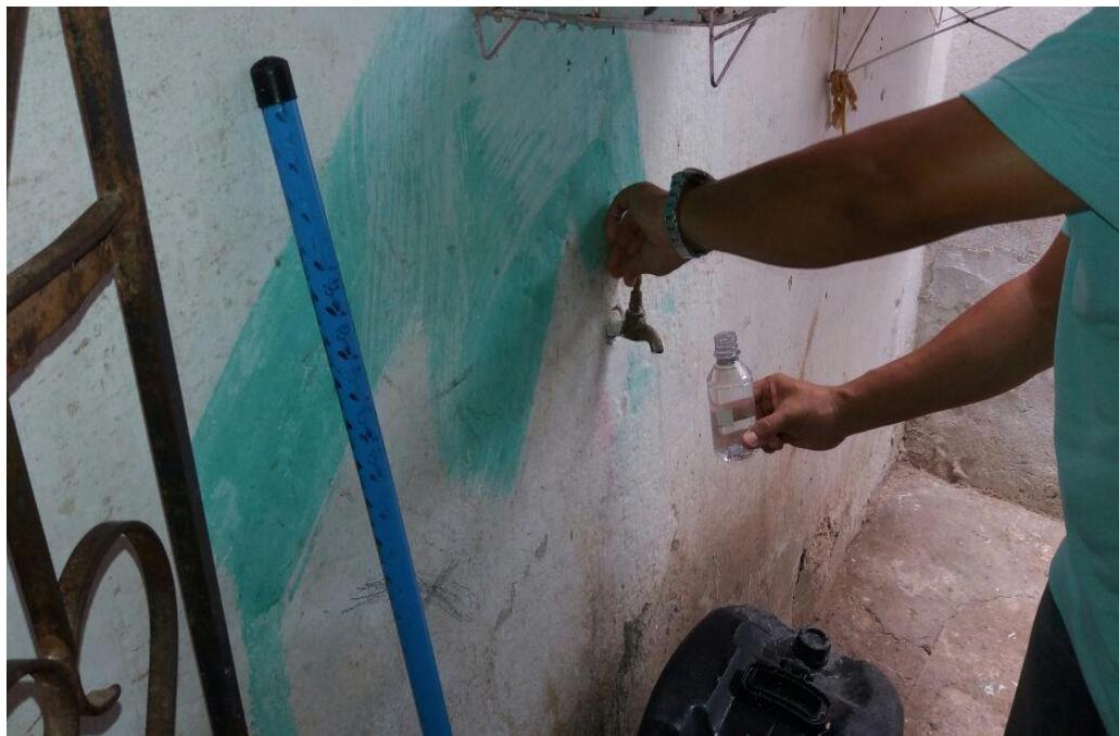
Figura 3- Procedimento de coleta de água nas residências
